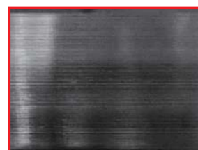
Přesnost povrchu stěny: Výška kroku =18 \mu\text{m}
